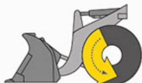
**Kein Druck** auf Inch-Brems-Pedal: volle Kraft für den Fahrantrieb
