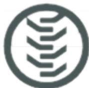
**EM** Profil: Mit fast parallel laufenden Lamellen für lose Böden wie Sand, Kies oder Schotter. Dieser Reifentyp erreicht eine große Aufstandsfläche, erzielt dadurch eine hohe Schubkraftübertragung und ist sehr laufruhig auf der Straße.
