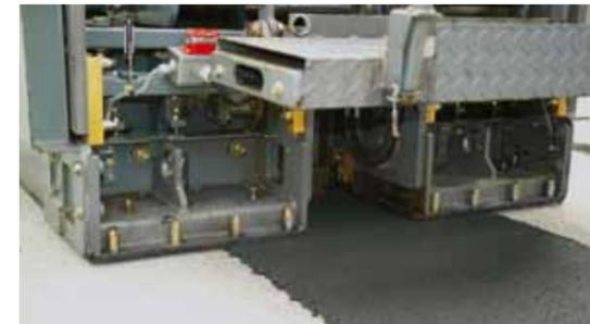
Stufenlos verstellbares Verschmälerungssystem
