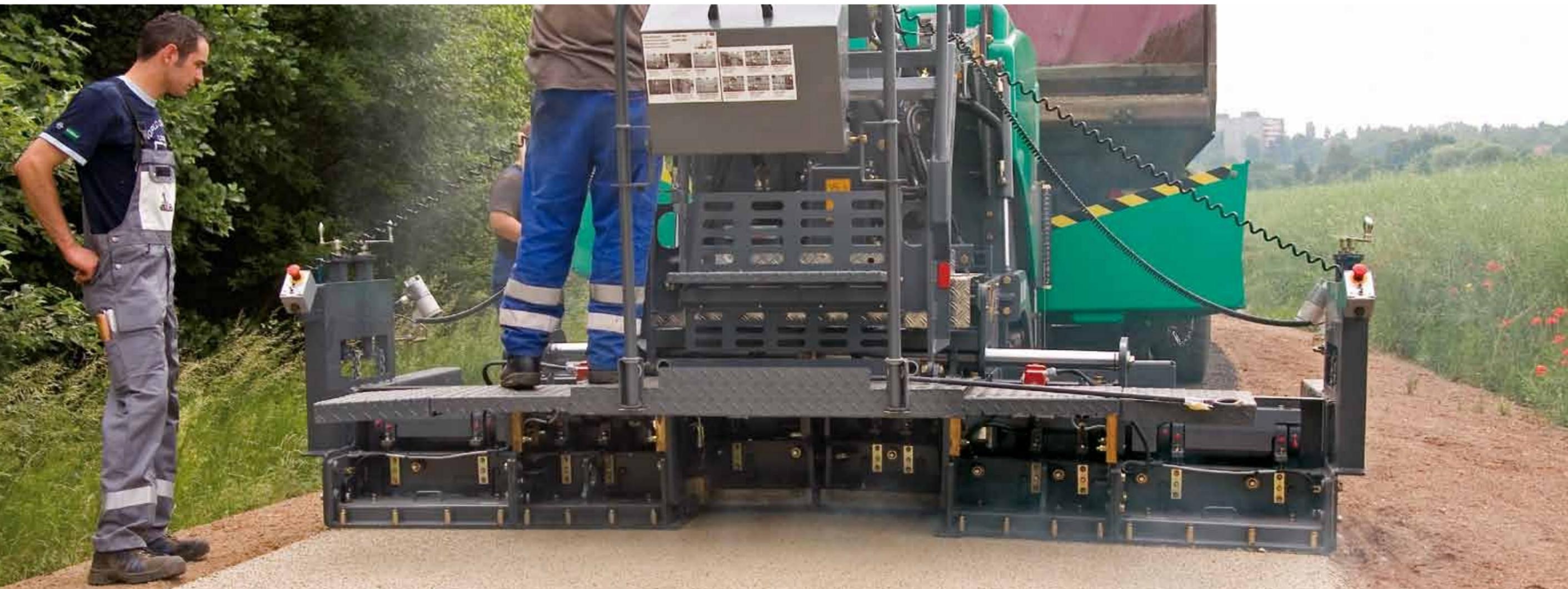
Die Einbaubohle AB 200 TV ist speziell für den Einsatz mit dem SUPER 800 konzipiert. Die Bohle verfügt über eine Grundbreite von 1,1 m und lässt sich hydraulisch auf eine Breite von 2 m ausfahren.
