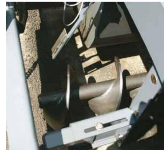
Auch die kleinen VÖGELE Fertiger verfügen über einen hervorragenden Materialtransport, der Entmischung verhindert und für eine gleichmäßige Materialverteilung vor der Bohle sorgt.
