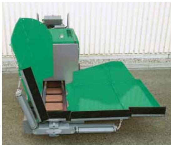
Die asymmetrische Bunkerwand (Option) erlaubt die Materialbeschickung mittels LKWs unter schwierigsten Baustellenbedingungen.
